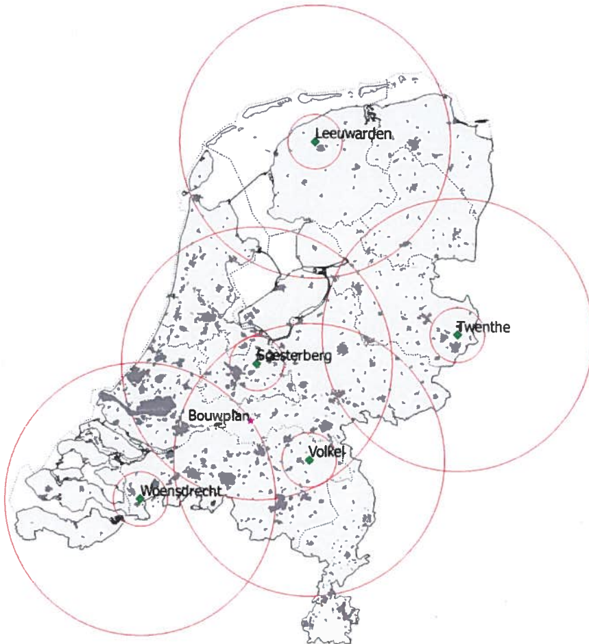
Figuur 2. Locaties van de vijf MASS verkeersleidingsradarsystemen (groene ruit) met daaromheen de 15 en 75 km cirkels. De donkergrijze vlakken zijn de in de AHN-1 gedefinieerde stedelijke gebieden. De ligging van het te toetsen bouwplan is aangegeven met een roze ster.
