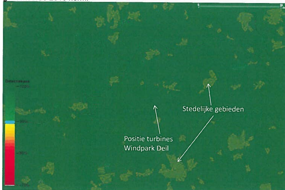
Figuur 5 Detectiekans van het MASS primaire verkeersleidingsradarnetwerk op 1000 voet boven het bouwplan voordat dit is gerealiseerd (baseline).
