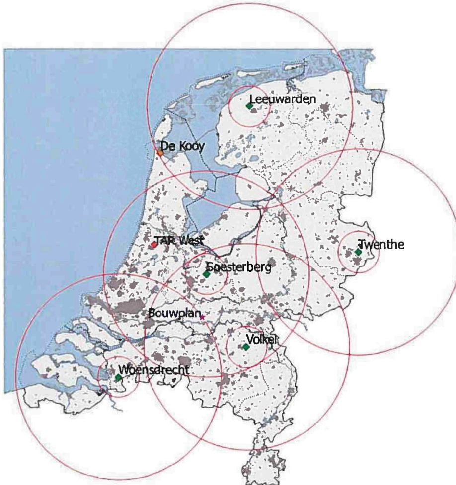
Figuur 2. Locaties van de vijf MASS verkeersleidingsradarsystemen (groene ruit) met daaromheen de 15 en 75 km cirkels. De TAR West radar bij Schiphol en de extra MASS radar bij De Kooy zijn aangegeven met een oranje ruit. De donkergrijze vlakken zijn de in de AHN-1 gedefinieerde stedelijke gebieden. De ligging van het te toetsen bouwplan is aangegeven met een roze ster.
