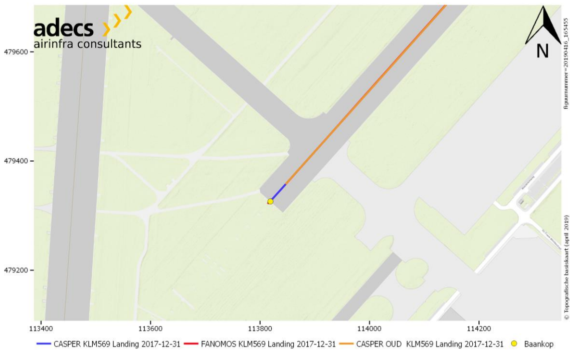
Figuur 4 Vergelijking tussen radartrack van een landing CASPER oud, CASPER en FANOMOS i.c.m. baankop.
