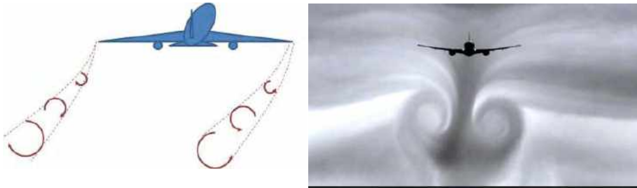
Figuur F.2: De dubbele vortex achter een vliegtuig (boven schematisch, beneden: in een werkelijke situatie)
