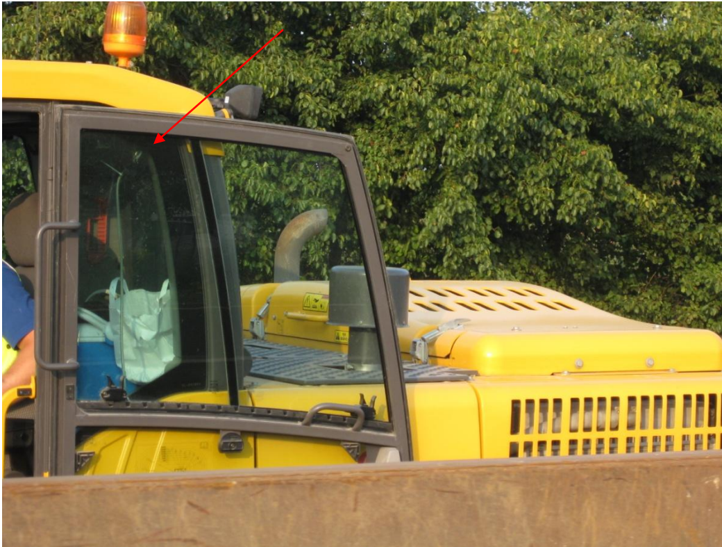
Foto 1.3: Positie monsternameapparatuur op graafmachine
