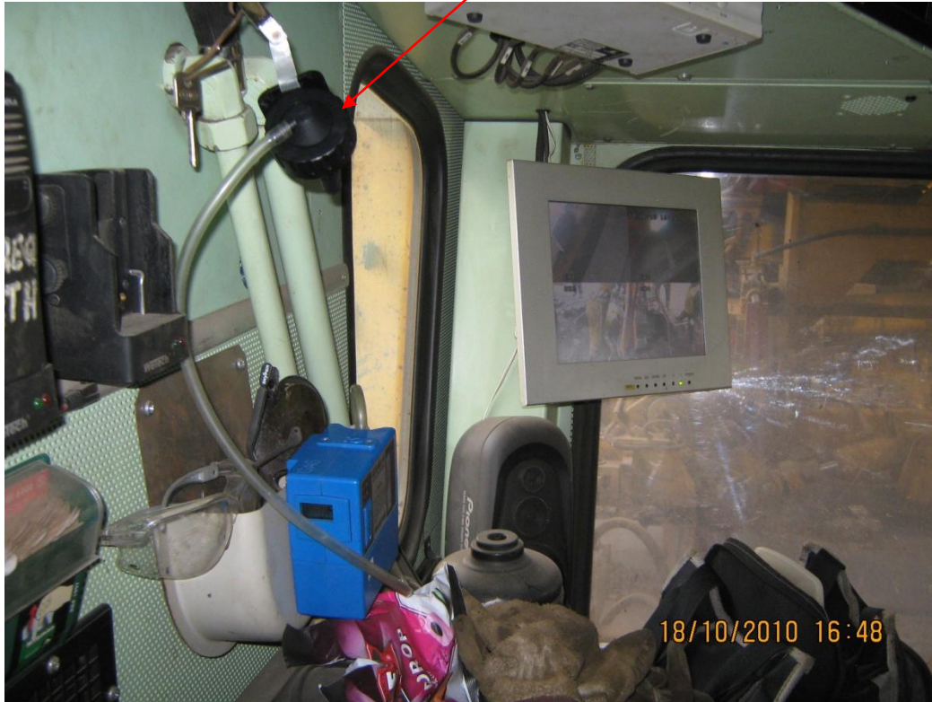
Foto 5.2: Monsternameapparatuur in de cabine van de kettinghor
