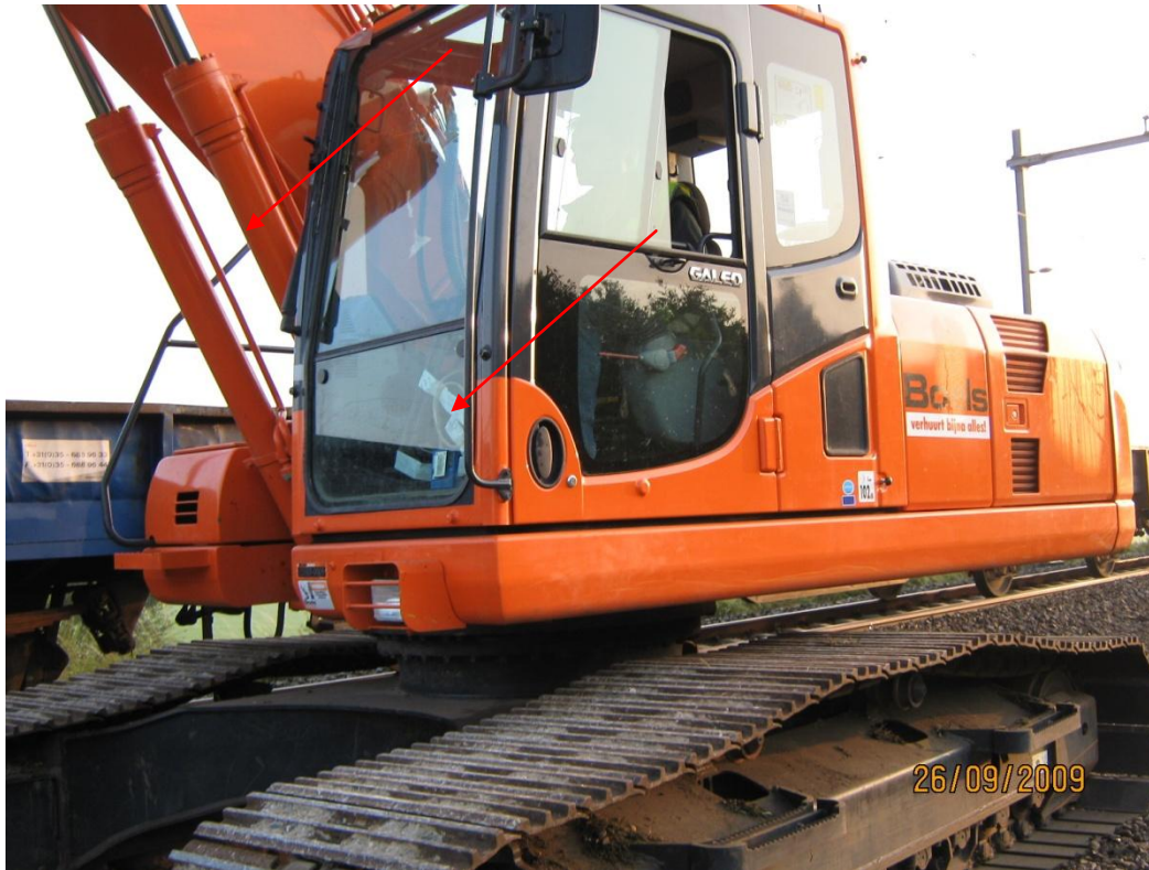
Foto 2.3: Positie monsternameapparatuur op graafmachine
