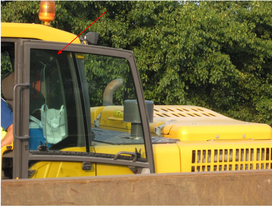
Foto 1.3: Positie monsternameapparatuur op graafmachine
