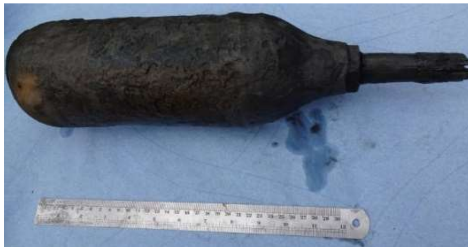
Figuur 50 4,2" springrook mortiergranaat (M8) direct na berging.
