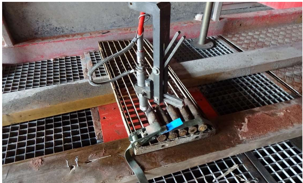
Figuur 9 Kop van de waterstraalsnijder met vijf 40 mm HE-brisantgranaten. Water en abrasief worden via rode leiding aangevoerd naar de spuitkop.
