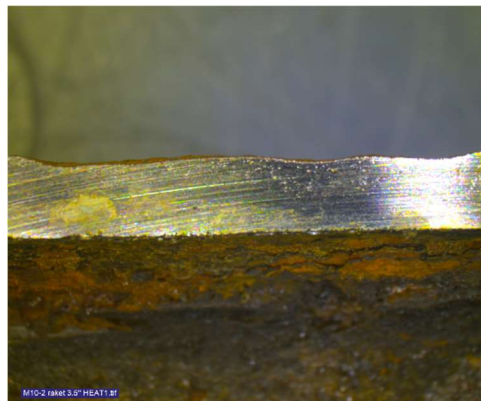
Figuur 57 Detail wanddikte M10-2 (radiale doorsnede).
