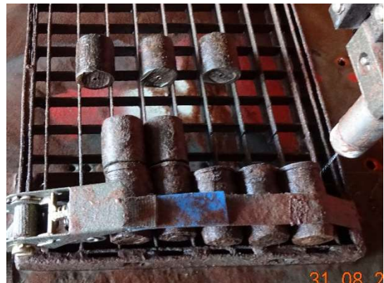
Figuur 25 M3-3 tot en met M3-7 na het waterstraalsnijden.
