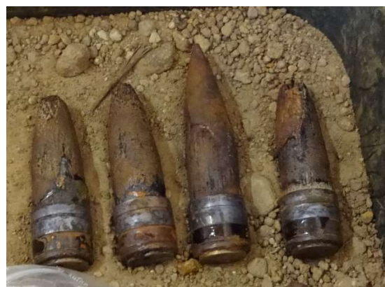
Figuur 29 Vier van de vijf 37 mm oefengranaten. Significante afname in wanddikte te zien rond de geleideband en aan de punt.
