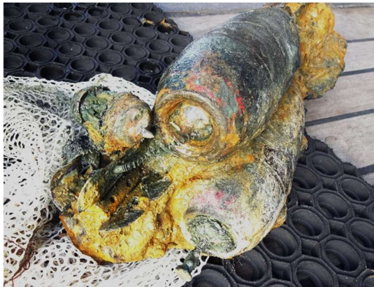
Figuur 46 3" mortier granaten (M7) met restanten ontstekers.
