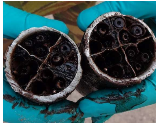
Figuur 56 Dwarsdoorsnede van de M10 raketmotor met busjes rookzwak kruit.
