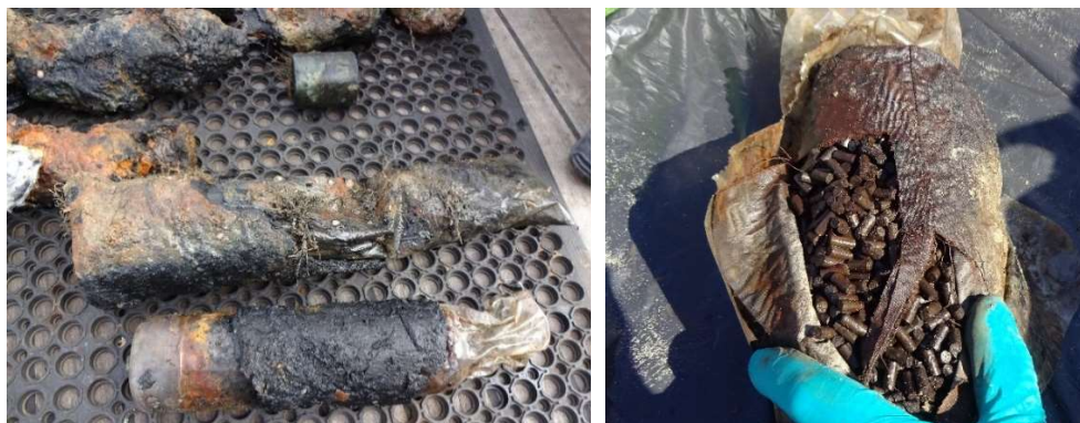
Figuur 61 M13 en M15 kardoezen direct na berging. Figuur 62 7-gats kruid afkomstig uit M13.
