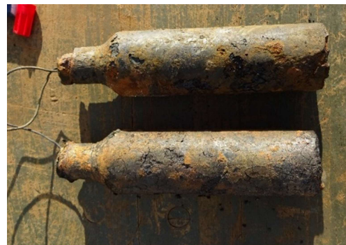
Figuur 54 M10 3.5" AT raketmotoren. Ontsteekdraden zijn nog aanwezig.
