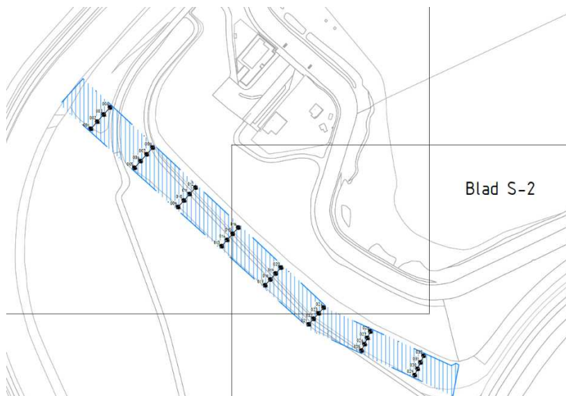
Figuur 30. Deelgebied D, waarbij indicatief het gebied waarin de TGG is aangebracht is gearceerd en het boorplan is weergegeven.
