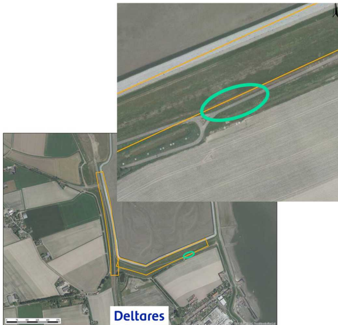
Figuur 35: Dijkvakken waarin TGG is toegepast (geel omrand), en de locatie waar de sporen zijn gevonden is groen omcirkeld.
