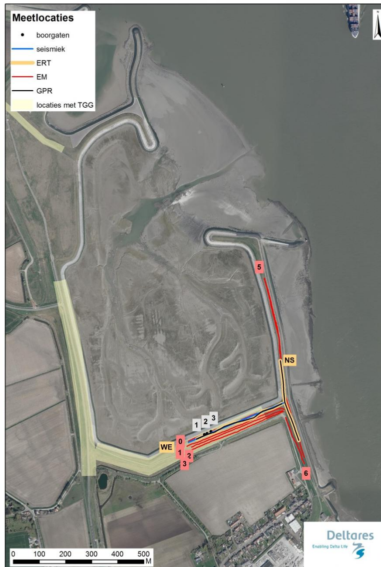
Figuur 5.4 Ligging van de meetlijnen met de verschillende geofysische technieken. ERT = Electrical Resistivity Tomograph, EM = Elektromagnetische inductie, GPR = Ground Penetrating Radar. De boorgaten zijn gebruikt voor EM-Slimflex metingen, voor cross-hole tomografie en VSP = Vertical Seismic Profiling
