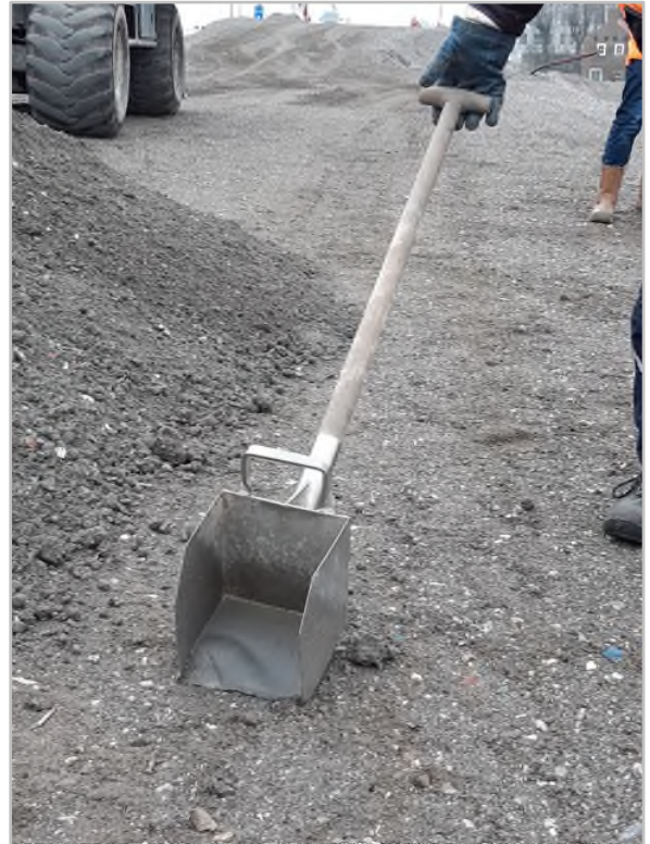
FOTO 2: BEMONSTERING MET BEHULP VAN EEN MONSTERSCHOP EN MOBIELE GRAAFMACHINE
