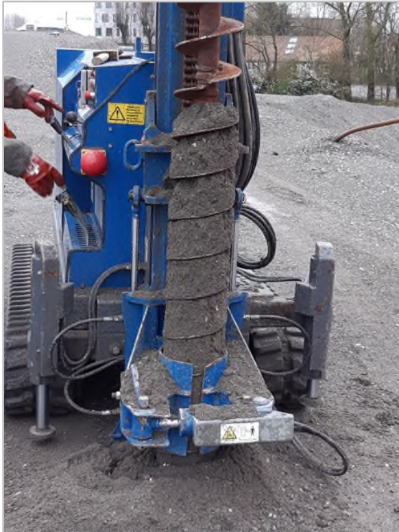
FOTO 1: BEMONSTERING MET BEHULP VAN EEN AVEGAARBOOR
