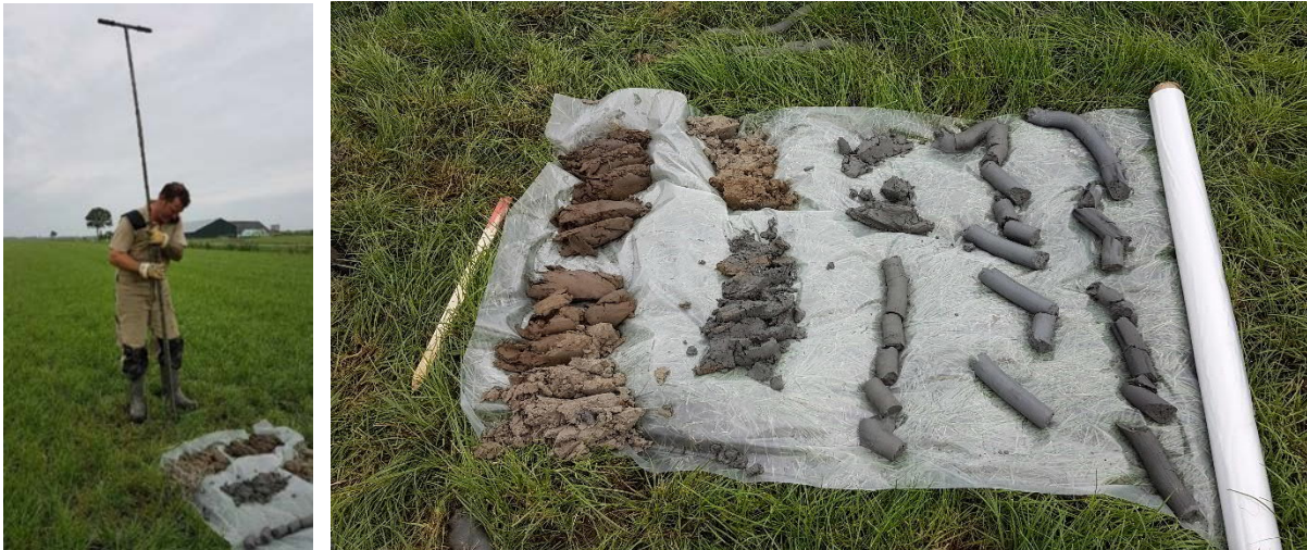
Fig. 2.3. Handmatige boring locatie Godlinze met rechts een foto van een uitgelegd boorprofiel
