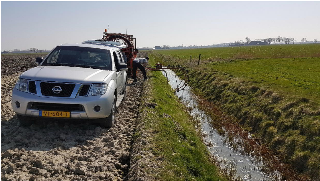
Fig. 2.7. Meting vlakteligging drainage en drainreiniger die de meetslang en sensor inbrengt (locatie Loppersum)
