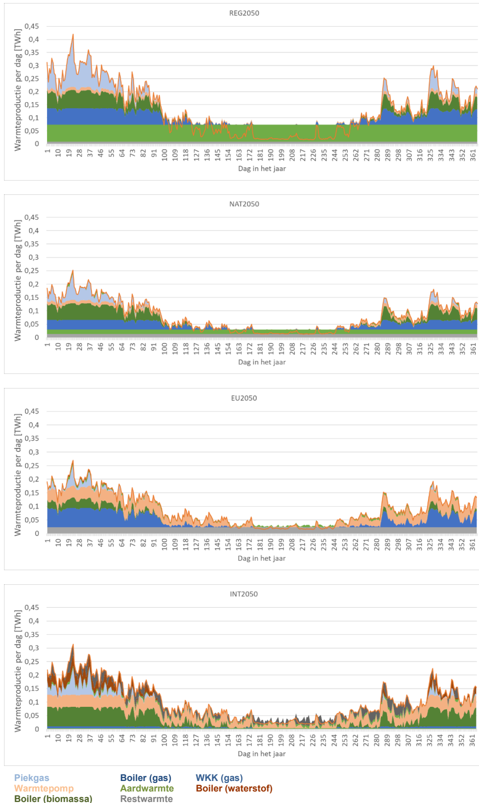
Figuur 6.1. Warmteproductie voor warmtenetten. Grafische weergave van de BK-scenario's zonder warmtebuffering. Voorbeelden van belangrijke warmtebronnen staan in de figuur aangegeven. De rode lijn geeft het verbruik weer.
