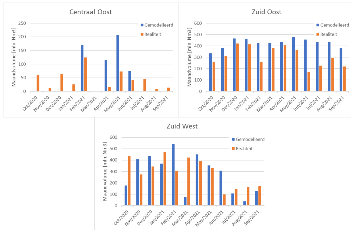
Figuur 3 Gemodelleerd maandvolume per cluster op basis van de operationele strategie inzet (blauw) versus het gerealiseerd maandvolume per cluster (oranje) in het gasjaar 2020/2021. Merk op dat de schaalverdeling verschilt per cluster.
