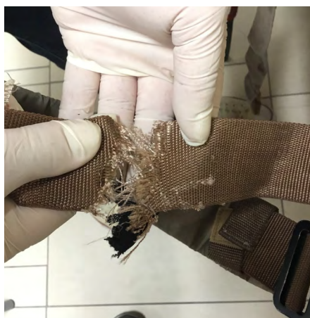
Figuur 20 Tijdens de redding doorsneden deel van de band (bron IVD)
