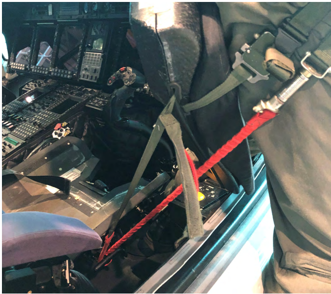
Figuur 23 Veiligheidslijn verstrikt achter stoel tijdens verlaten helikopter (bron IVD)
