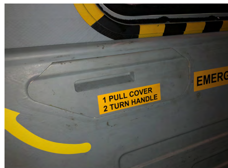
Figuur 25 Afdekluisje hendel uitwerpmechanisme cabinedeur (bron IVD)
