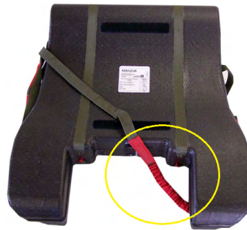
Figuur 16 CSP met de rode veiligheidslijn (bron onderhoudsmanual)
