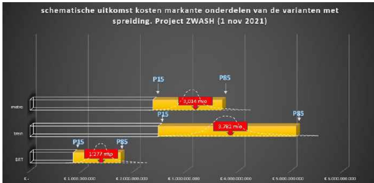
Figuur 13 Schematische weergave van de kosten met onderkende risico's en onzekerheden voor markante onderdelen uit projectalternatieven. Het betreft metro uit projectalternatief 3.2, trein uit projectalternatief 2 en BRT uit projectalternatief 1.
