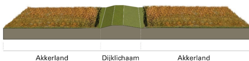
Afbeelding 36: Perspectiefdoorsnede nieuwe lage dijk Ven-Zelderheide Zuidvariant
