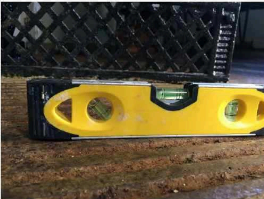
Figuur 5: schuine van vloer met waterpas, ca. 8 cm over 2 m afstand
