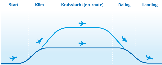
Figuur 31: Verschillende vluchtfases: van de start via de kruisvlucht tot aan de landing
