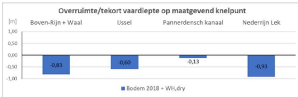
Figuur 32. Overruimte/tekort vaardiepte bij kritieke knelpunten op de Waal, Nederrijn en IJssel onder het warme en droge klimaatscenario (WHdry) en de huidige bodem ( referentie 20 )
