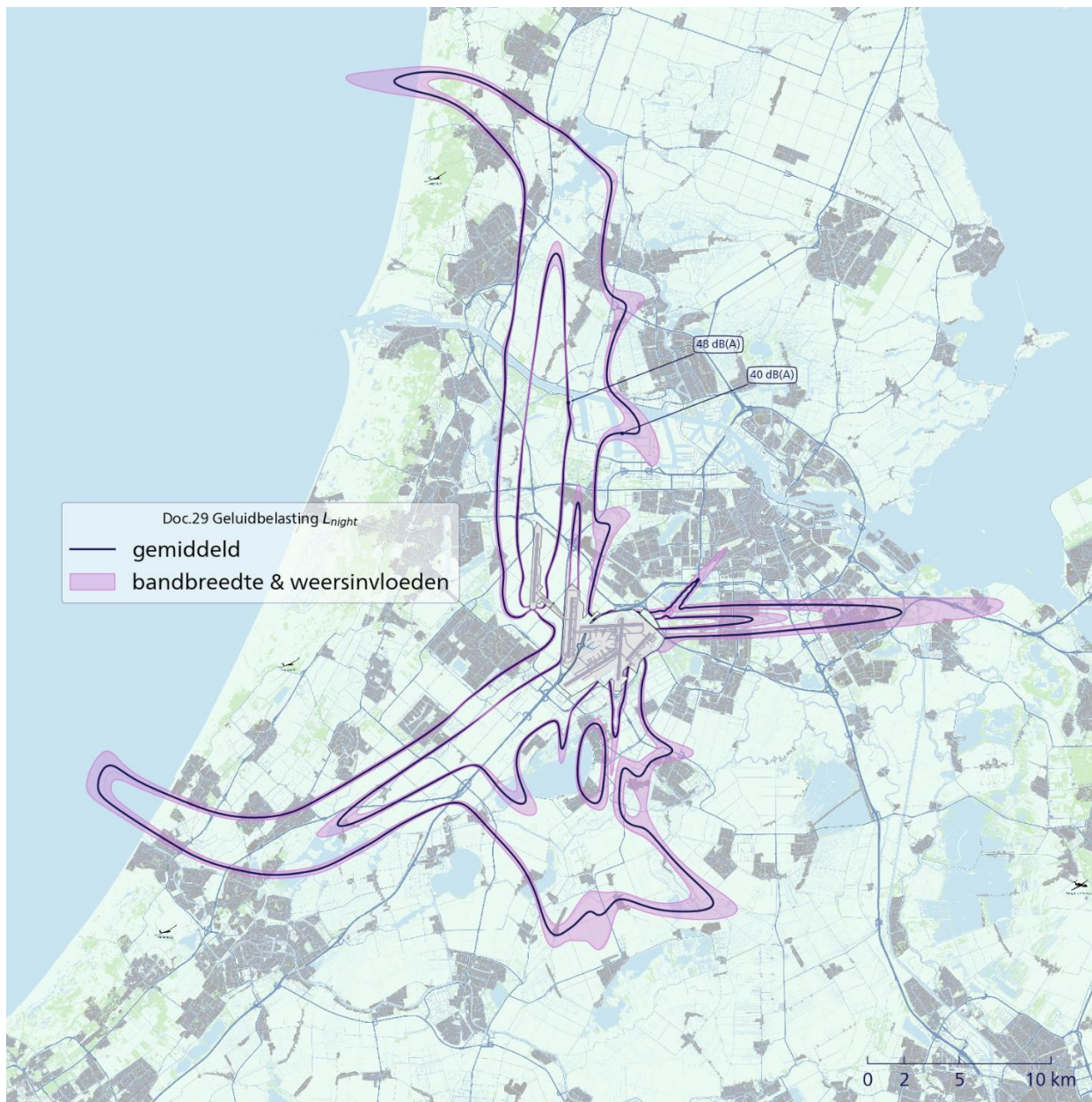
Figuur 5.2: Verwachte jaargemiddelde geluidbelasting over de nachtperiode L_{night} met spreiding als gevolg van bandbreedte en weersvariaties (Doc.29).
