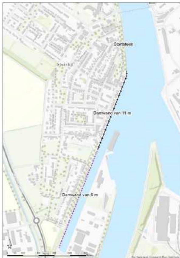
Figuur 3.26 Oeverconstructies langs het kanaal
