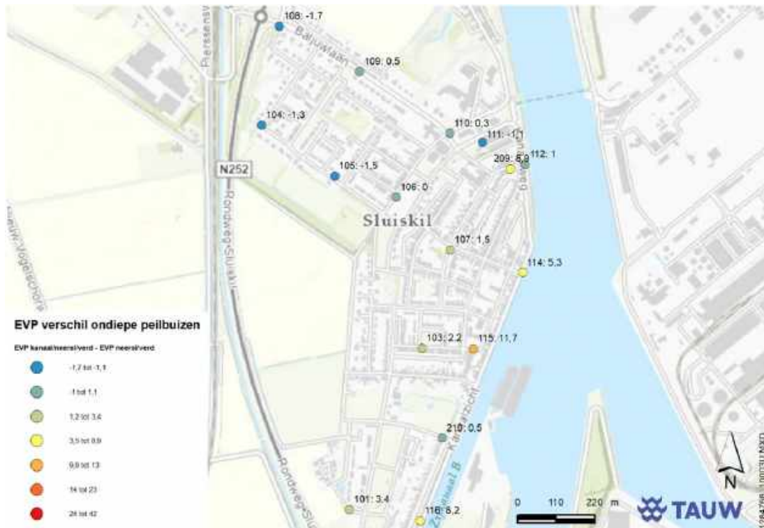
Figuur 1 Verschil in voorspelbaarheid tussen een tijdreeksmodel met neerslag, verdamping en het kanaalpeil als verklarende reeksen versus de voorspelbaarheid van een tijdreeksmodel met alleen neerslag en verdamping als verklarende reeksen. Weergegeven zijn de ondiepe peilbuizen in het gebied.
