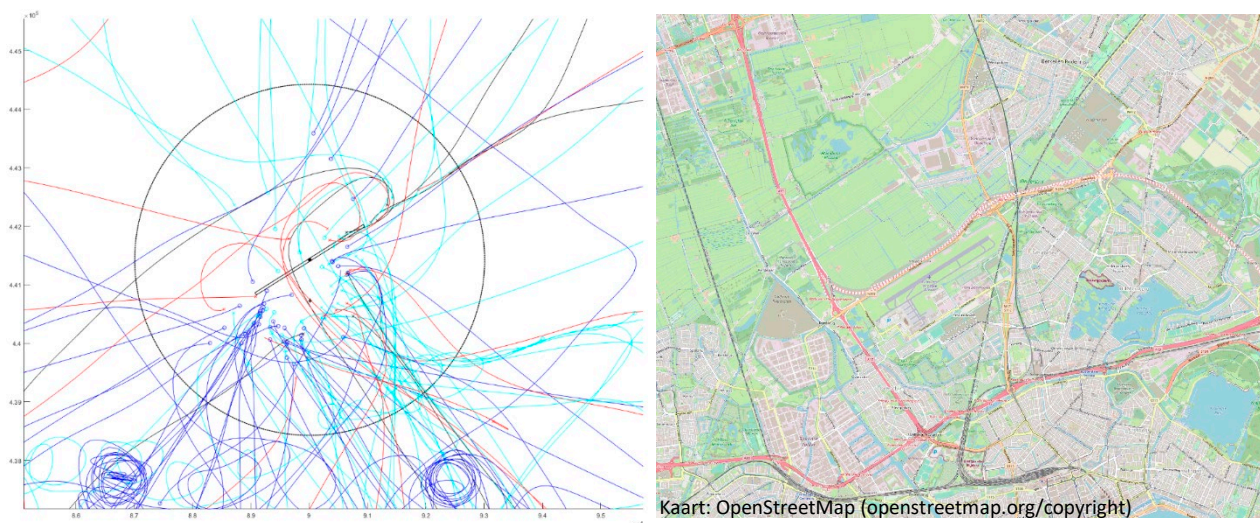
Figuur 5: Links: niet-verlengde vliegbanen voor enkele dagen helikopterverkeer, weergegeven samen met de start- en landingsbaan van Rotterdam en het gebied dat binnen 3 km vanaf het midden van de baan ligt. Rechts: ter referentie, een topografische kaart van hetzelfde gebied
