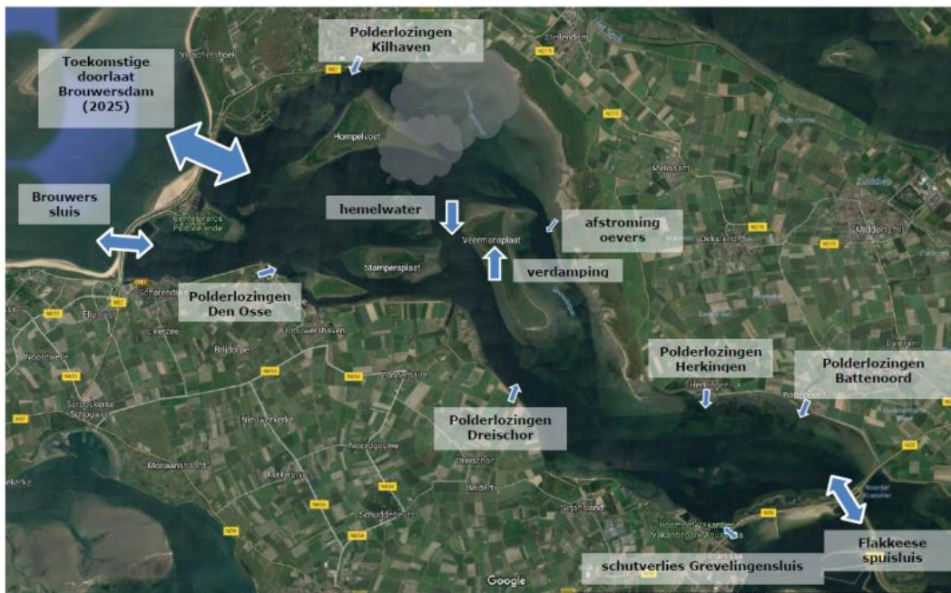
Figuur 6.2: Brouwerssluis, toekomstig doorlaatmiddel Brouwersdam, Flakkeese spuisluis en andere vormen van watertoevoer en –afvoer
