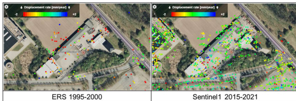
Figuur 7: Weergave van de bodemdalingssnelheid op basis van INSAR-data gedurende 1995-2000 en 2015-2021 boven caverne Stade T5 (bron: SkyGeo portal voor Nobian). Dit gebied is gekozen omdat het het centrum van het bodemdalingsgebied was, caverne T5 ook de grootste caverne was, en de gebouwen sinds 1995 onveranderd zijn, waardoor de data uit beide periodes goed vergelijkbaar is. Te zien is dat in de periode 1995-2000 bodemdaling plaatsvond met een snelheid van 2 mm/jaar. Destijds was het winningsgebied nog in bedrijf. Waterpasgegevens geven een vergelijkbaar beeld. In de periode 2015-2020 (10-15 jaar na abandonment van de putten) is de bodemdalingssnelheid 0 mm/jaar.
