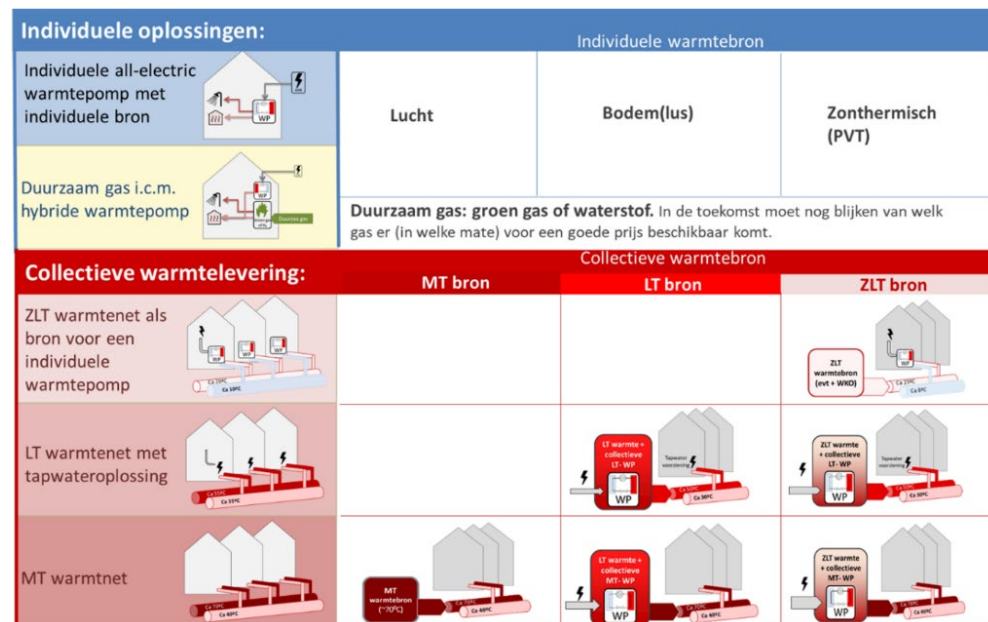
Figuur 6. Overzicht technische oplossingen voor verwarmen.
