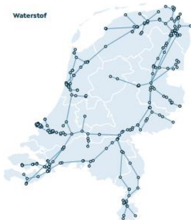
Figuur 1-2 - Configuratie transportnetwerk voor waterstof in 2050 (NetbeheerNL, 2021)
