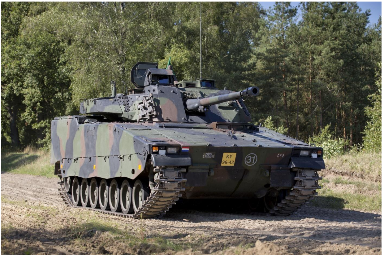
Afbeelding 1 CV90: lengte 6,47m, breedte 3,01m en hoogte 2,83 (tot hoogste punt koepel). Bron: Mediatheek Rijksoverheid.
