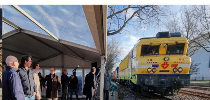
Eerste batterijlocomotief voor werkzaamheden aan het spoor
