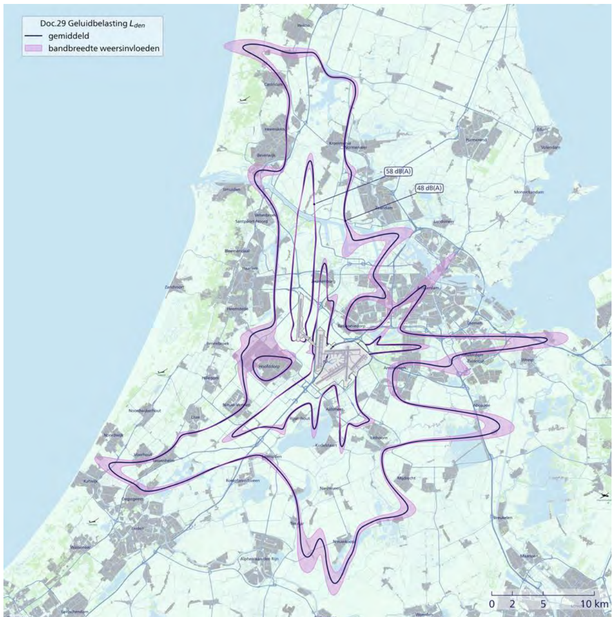
Figuur 5.1: Verwachte jaargemiddelde geluidbelasting met spreiding als gevolg van weersvariaties (Doc.29), inclusief de effecten als gevolg van baanonderhoud
