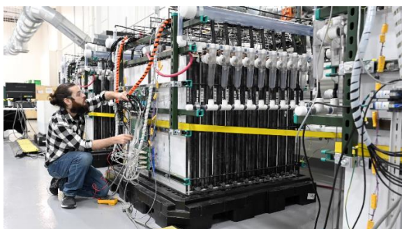
Figuur 11. IJzer-zuurstof batterijen als proefopstelling
