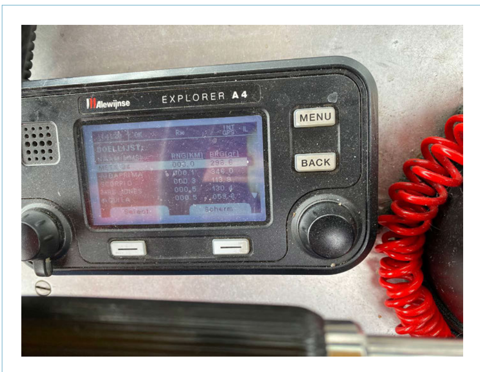
Figuur 10: AIS-systeem aan boord van de MSTX 6, vergelijkbaar met die van de MSTX 21.
