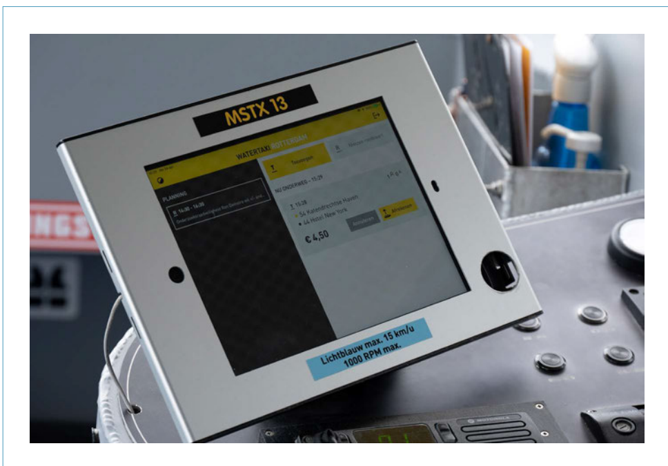
Figuur 14: Tablet gebruikt voor de routeplanning en ritregistratie op een watertaxi.
