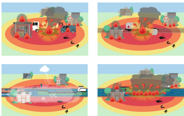
Figuur 33 Vier scenario's uit het Scenarioboek, v.l.n.r.: tankauto benzine, ketelwagen benzine, tankschip ammoniak, tankschip benzine. Benzine is geselecteerd als representatief voor LOHC.
