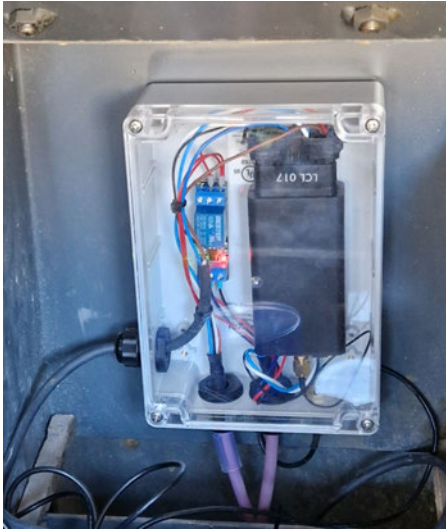
Figuur 5: Ingebouwde waterdichte LCL-dongle.
