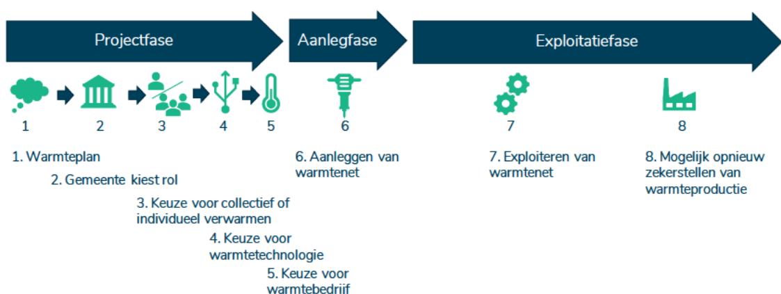
Figuur 12 Stappen bij aanleg (of uitbreiding) van een warmtenet. Bij besluitvorming van warmtenetten op drie momenten bepaalde mate van concurrentie; 'of' er een warmtemarkt komt (3), 'voor' een markt met bepaalde technologie (4), 'om' de markt (5). Daarna is er geen concurrentie 'op' de markt (7), in die fase is regulering mogelijk nodig.
