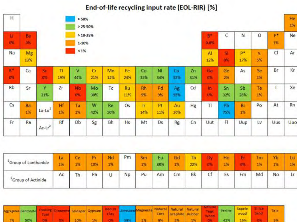
Figuur 15: Het huidige recyclingpercentage aan het einde van de levensduur, bijvoorbeeld het percentage dat de huidige recycling bijdraagt aan de totale vraag naar een specifiek element. ( Bobba et al., 2018 ) 7 .
