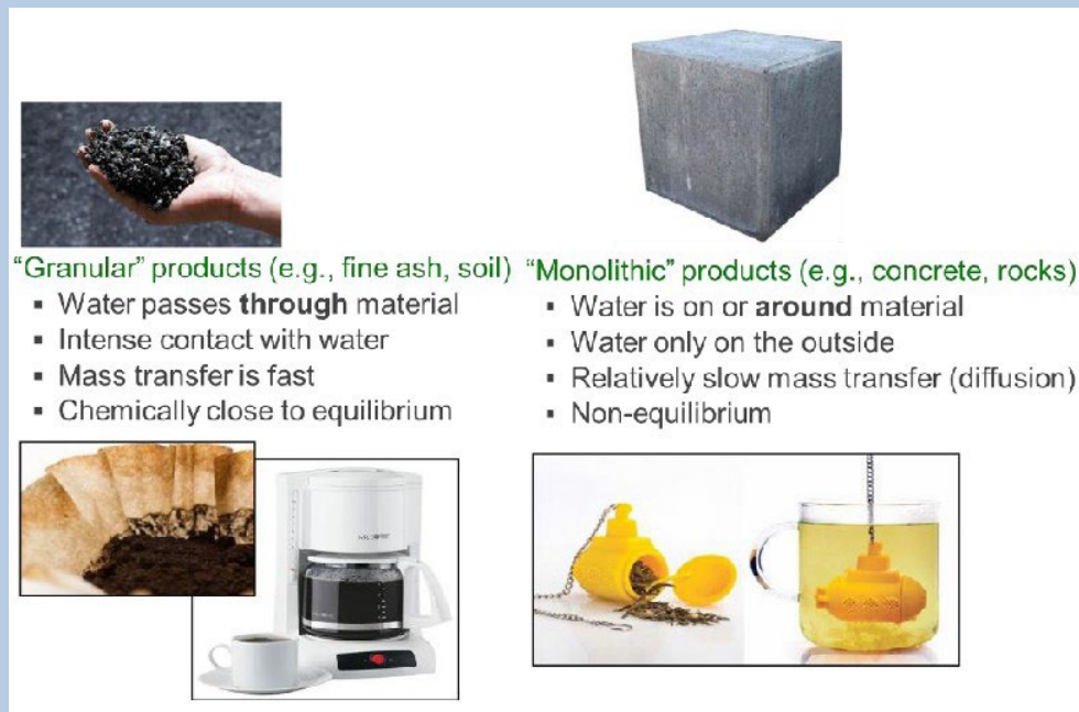
Figuur kader: het onderscheid tussen percolatie gecontroleerde uitloging (links) en diffusie gecontroleerde uitloging (rechts) (respectievelijk dominant bij niet-vormgegeven en vormgegeven bouwstoffen) is te vergelijken met het zetten van koffie of thee (overgenomen uit Dijkstra, (2024)).
