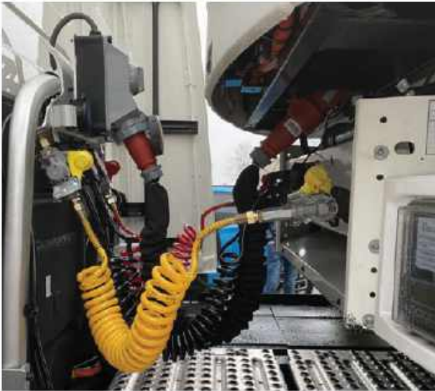
Afbeelding 2: voorbeeld e-PTO stekker. Bron: presentatie Simon Loos.
