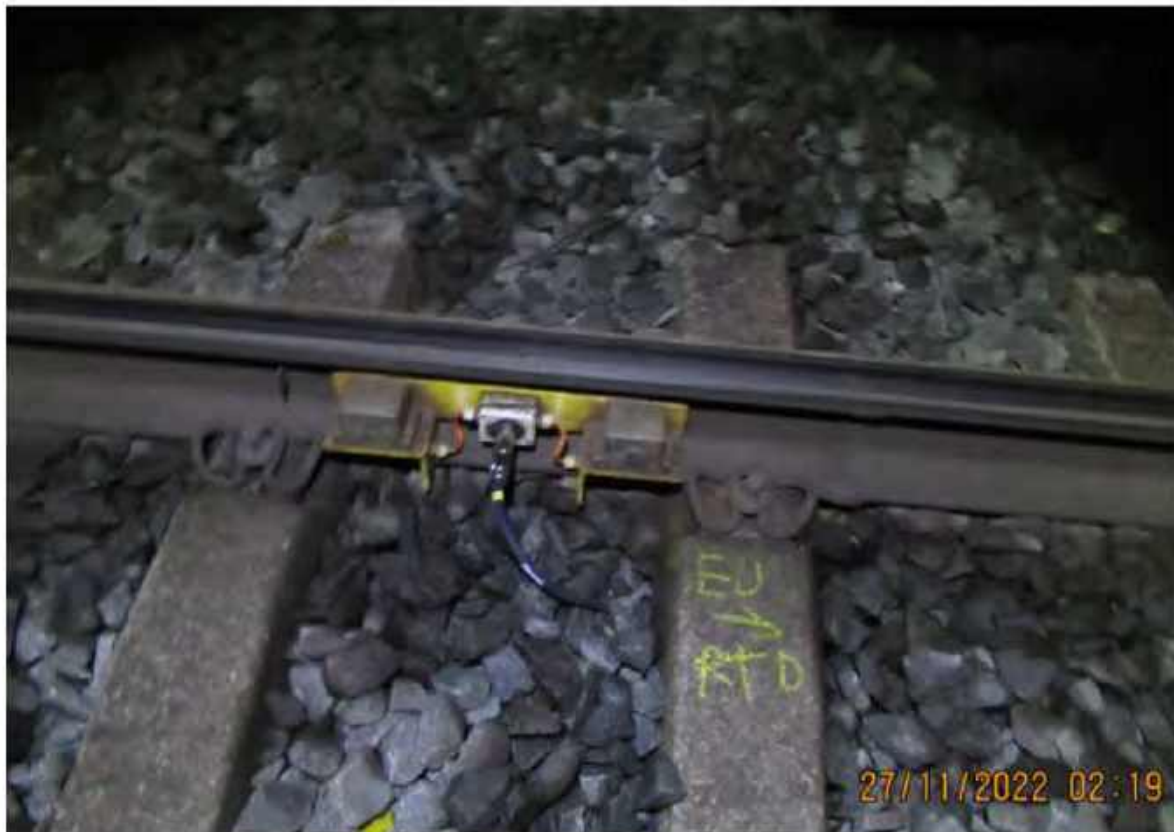
Foto 5: Inductieve sensor in het spoor t.h.v. de referentiedoorsnede.
