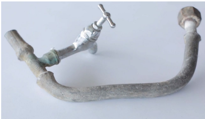
Figuur 3: Loden leiding (bron: Drinkwaterplatform)
