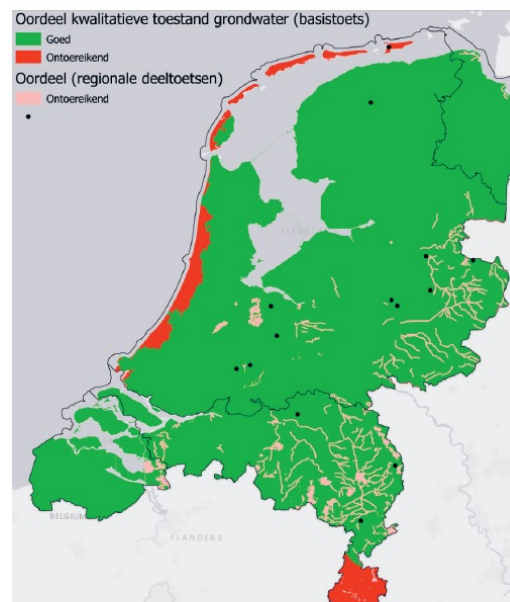
Figuur 3-f. Kaart van de stroomgebieden Rijn, Maas, Schelde en Eems met de algemene kwalitatieve beoordeling van grondwaterlichamen (groen = goed; algemene toestand ontoereikend = rood, regionaal oordeel ontoereikend = roze of zwarte stip bij drinkwaterwinningen).
