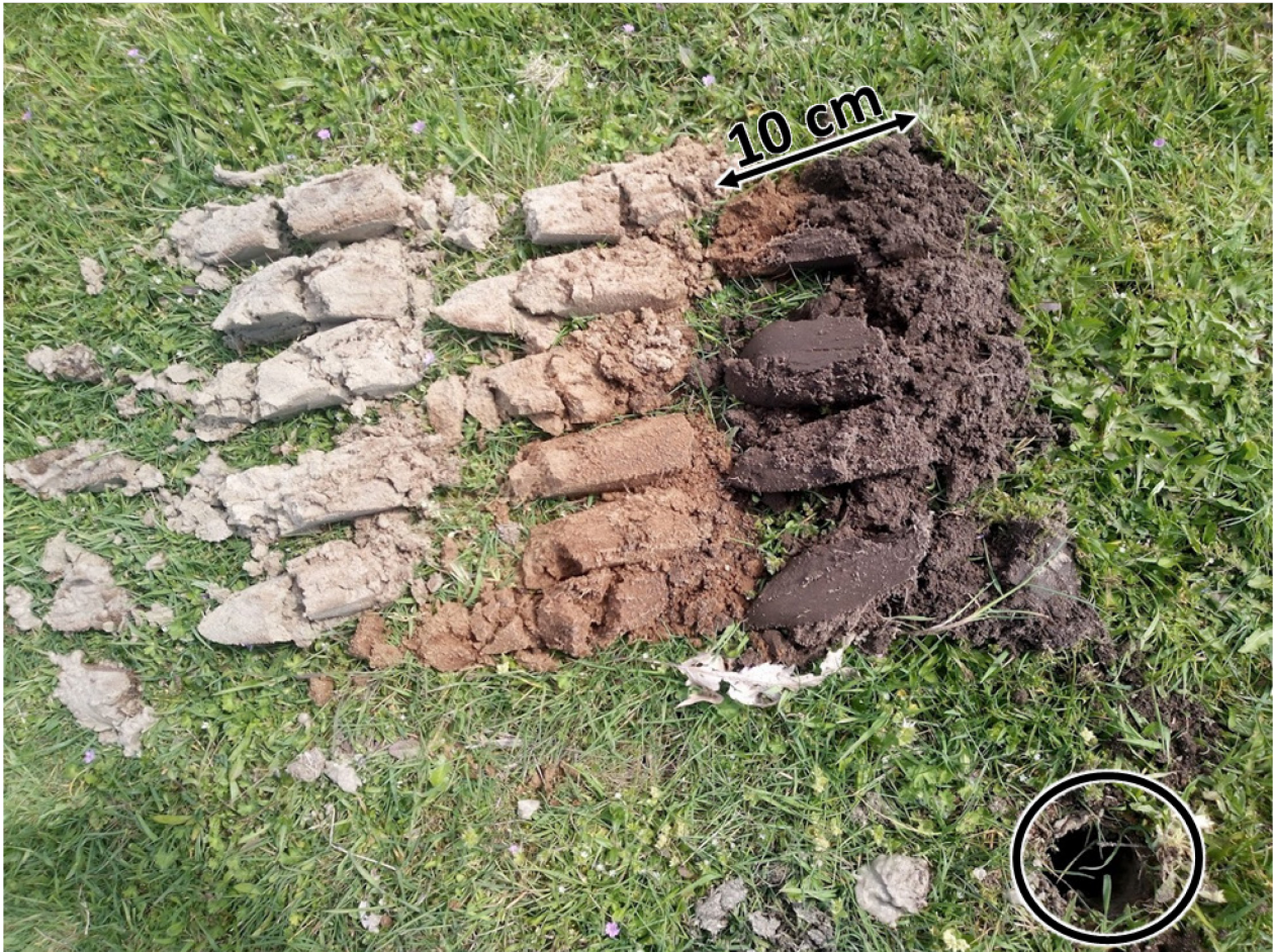
Figuur 1 Voorbeeld van een bodemprofiel. Alleen op basis van kleur zijn er in dit geval al drie horizonten te onderscheiden. In het veld kan de veldbodemkundige mogelijk nog meer horizonten onderscheiden op basis van tast en zicht. Met de edelmanboor wordt elke keer ongeveer 10 cm materiaal opgeboord. Het boorgat is rechts onderin te zien.
