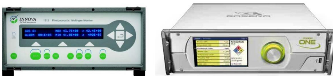
Figuur A6 Twee voorbeelden van fotoakoestische gasmonitoren voor het meten van gasconcentraties bij boxmetingen. Links: Innova 1312 (LumaSense Technologies, Denemarken); Rechts: Gasera One (Gasera Ltd., Finland).
