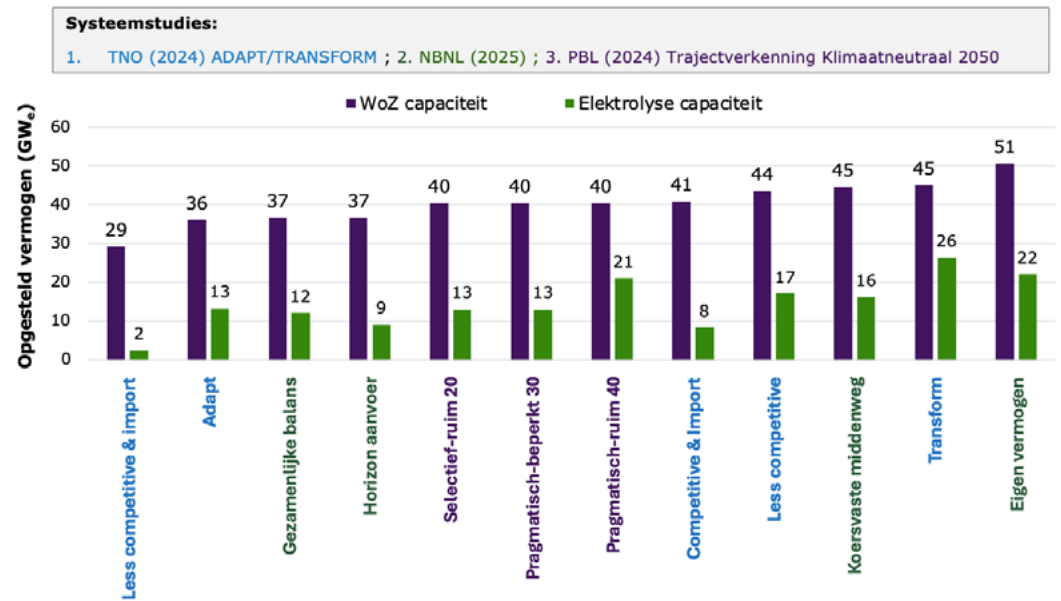
Figuur 2-6 – Verband tussen de productiecapaciteit van windenergie op zee en de elektrolysecapaciteit in 2040 in de systeemstudies van TNO, PBL en NBNL
