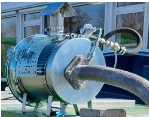
Figuur 4.3: Geplaatst opsteekfilter in bijbehorende behuizing.
