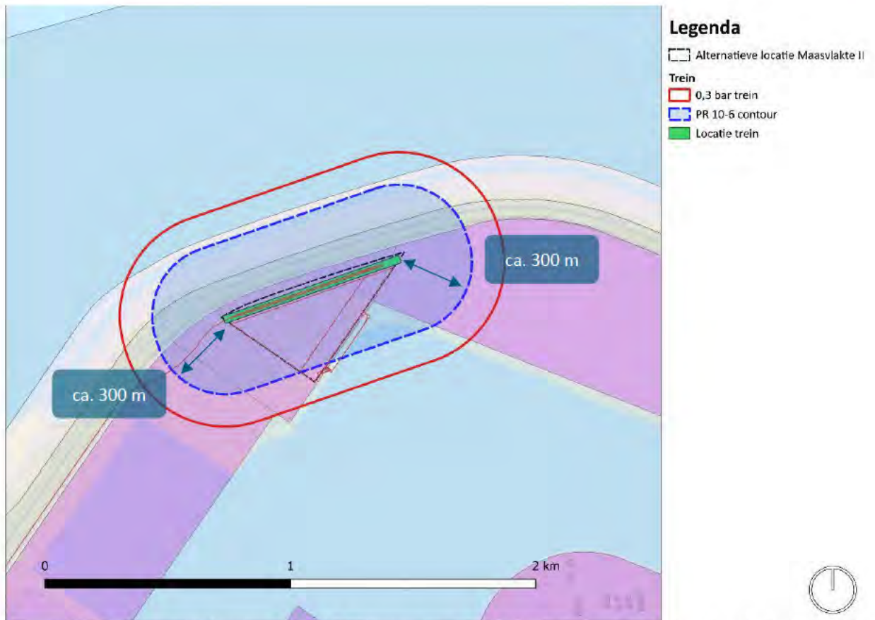
Figuur 3-21 De 0,3 bar overdruk contour en de PR 10-6-contour van de trein op basis van voorgaande onderzoek: Resultaten QRA Defensieterrein RWG v2 (TNO, 2025). Daarnaast is de enkelbestemming bedrijf weergegeven.
