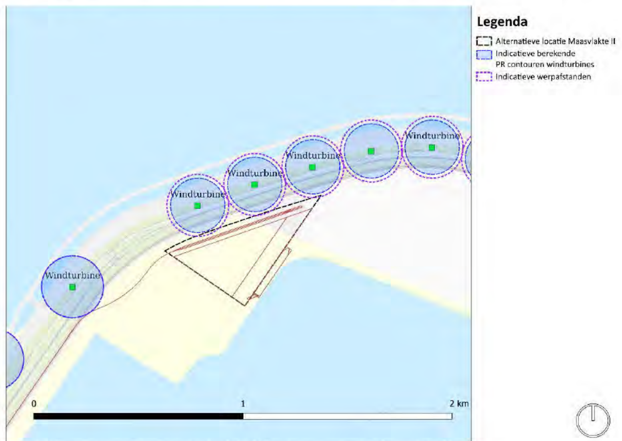
figuur 3-19 Indiatieve werpafstanden en berekende PR-10 -6 -contouren van de nabijgelegen windturbines
