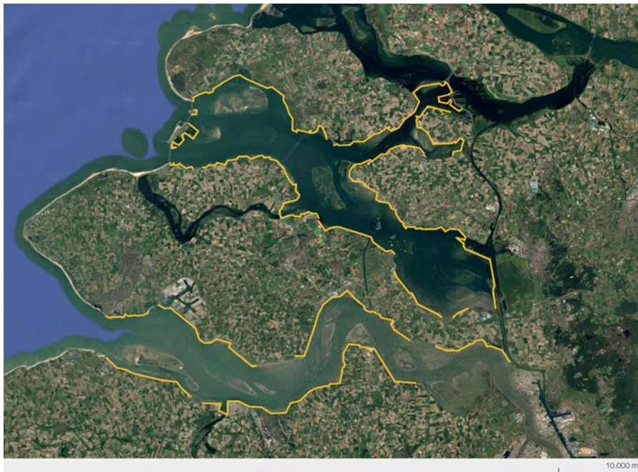
Figuur 11. Geïdentificeerde potentiële schikte dijklichamen voor de Ooster- en Westerschelde, respectievelijk 165,7 km en 99,8 km in lengte.
